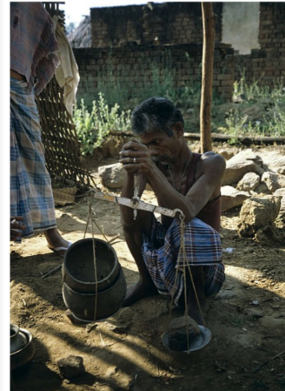
Metall wird gewogen und in die Reservoir gefüllt
