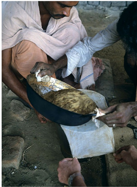
Wachs wird durch ein Tuch gegossen
