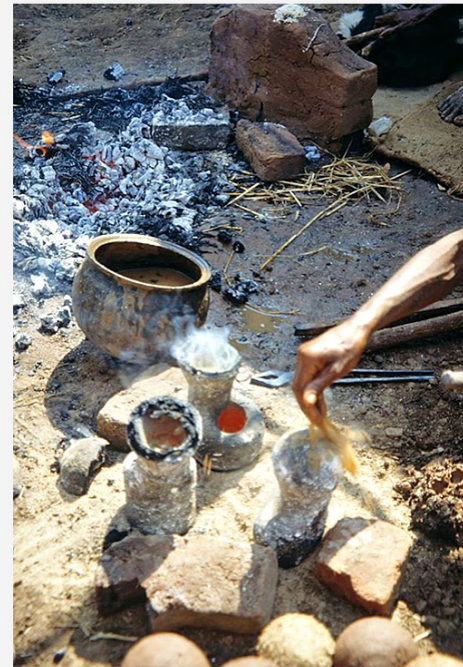
Gussform wird mit Wasser abgekühlt
