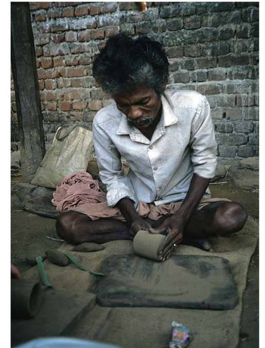
Die Positive werden an der Oberfläche auf Holzbrett geschliffen
